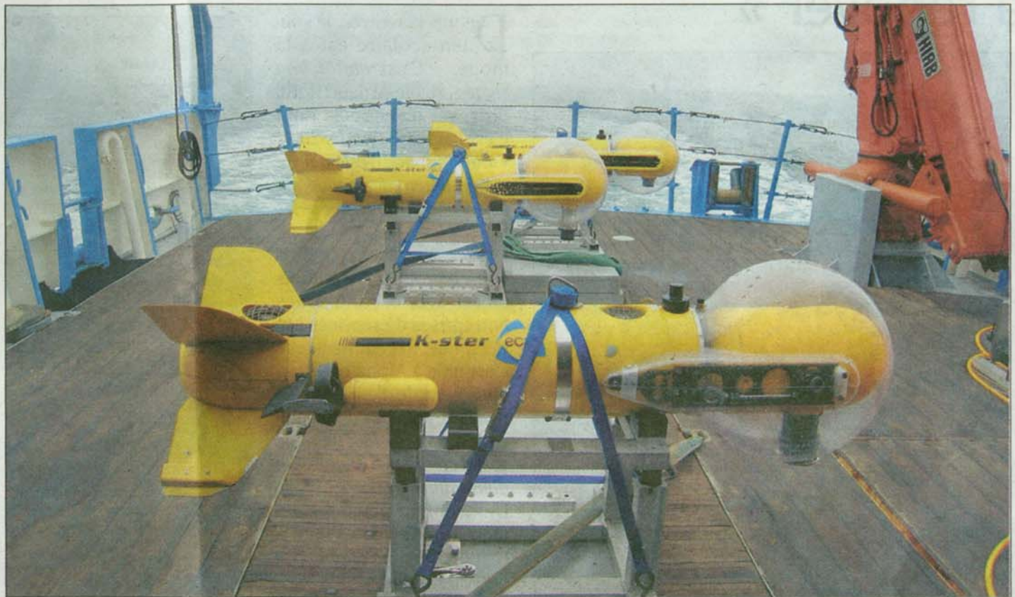
K-Ster : ce destructeur de mines à tête pivotante est fabriqué par l'entreprise Eca.
